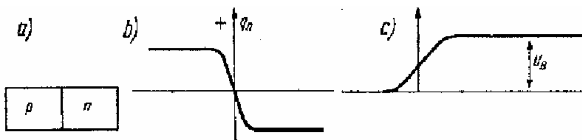
Rys. 75. Złącze pn: a) schemat, b) gęstość ładunków większościowych, c) rozkład potencjału [opracowanie własne]
